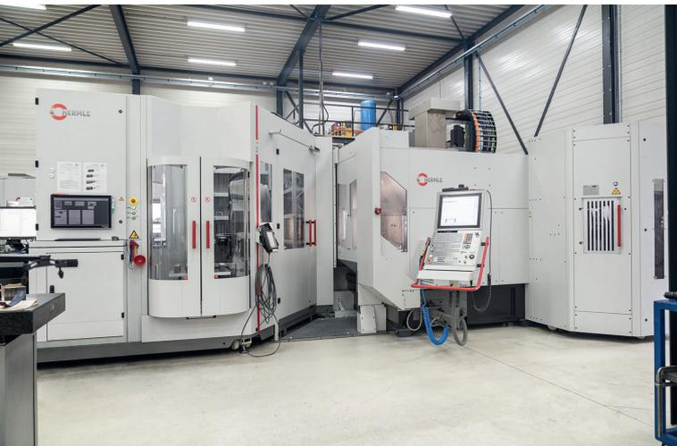
**3** Das Robotersystem 'RS 1' versorgt die Hermle C 400 U kontinuierlich mit zu bearbeitenden Teilen – Tag und Nacht © Hermle
