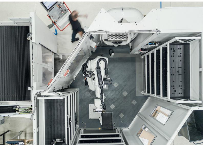
5 Die C 400 U ist durch das Robotersystem 'RS 1' automatisiert – perfekt für das Teilehandling bei der Bearbeitung von Serien © Hermle
